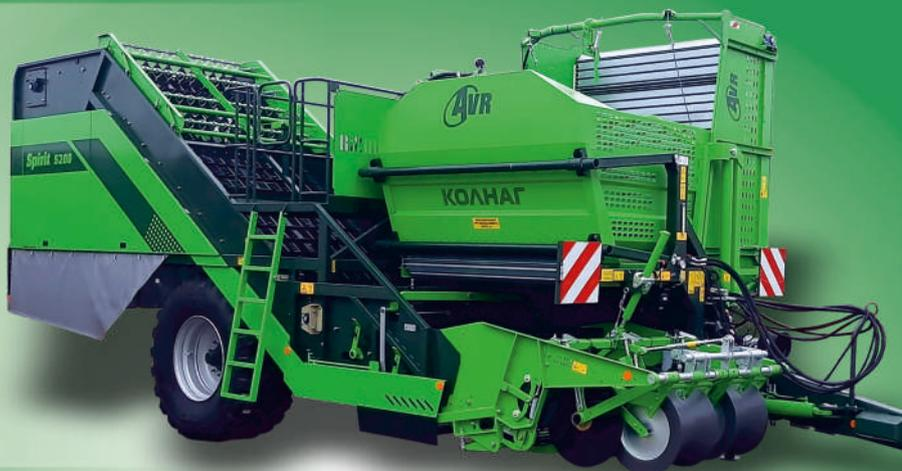
В комбайне AVR Spirit 5200 используется механический привод транспортеров от ВОМ трактора. AVR Spirit 5200 менее требователен к гидросистеме и мощности трактора при сохранении всех преимуществ комбайнов этой серии.
